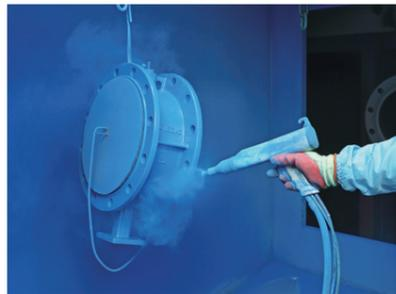
электростатическое напыление эпоксидного покрытия
