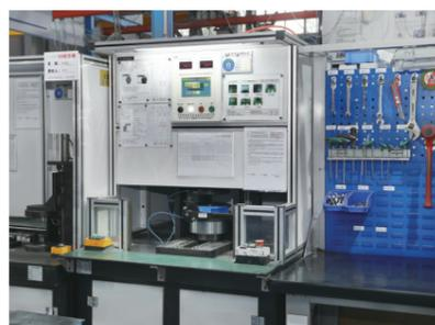
Оборудование для испытаний под давлением без воды
